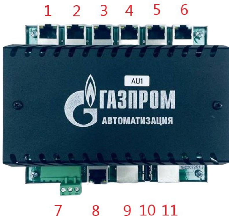
Рисунок 1 - Внешний вид модуля МИБ-08 и расположение элементов
