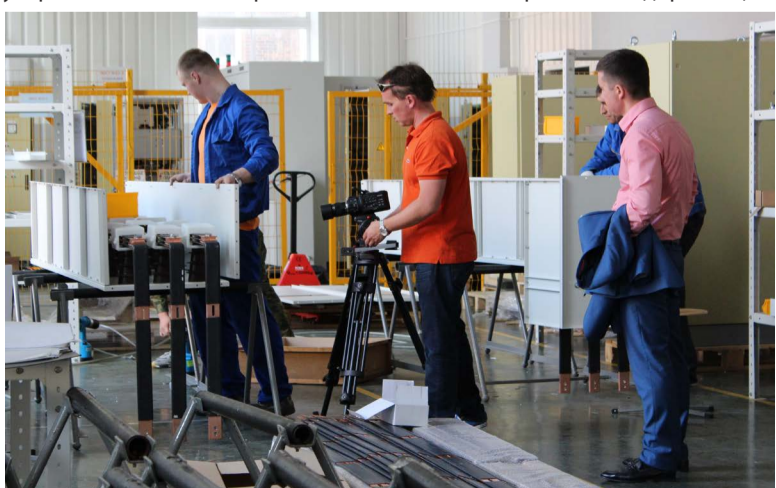
Процесс сборки шинного моста. Участок сборки зарядно-выпрямительных устройств. ООО Завод «Калининградгазавтоматика»
