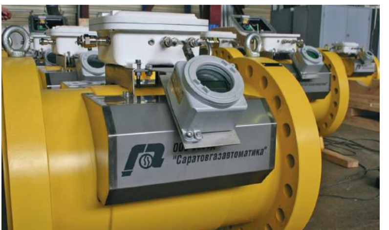
Ультразвуковой расходомер MPU 200 DN 400
